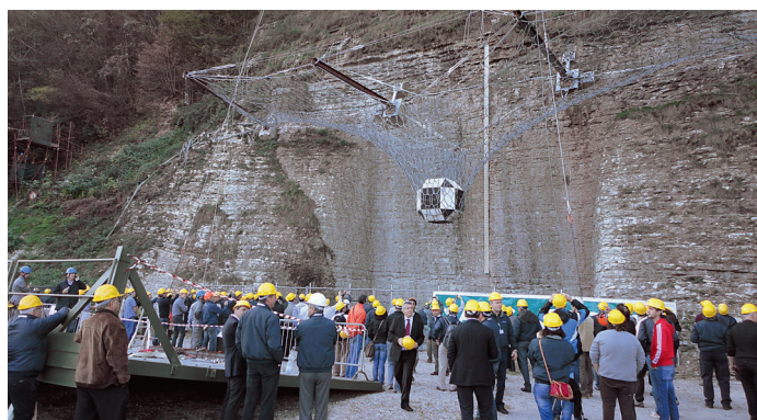
Сертификационные испытания системы противокамнепадных барьеров
